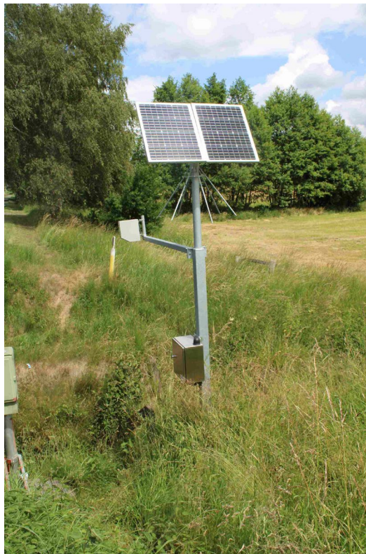
Foto 1: Messeinrichtung zur Abflussbestimmung am Nordbach bei Salzhausen
