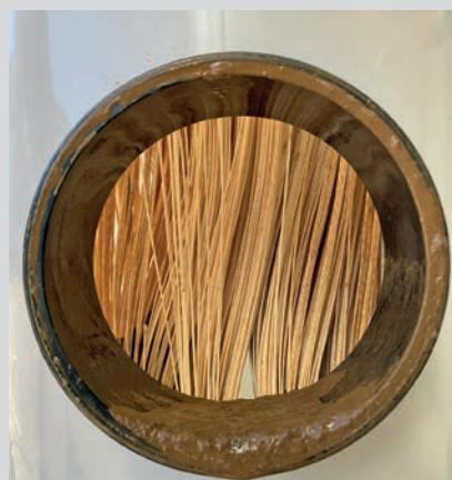
Blick in den Modulbehälter auf die Polymermembran.
