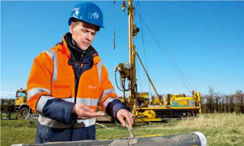
MIT KNOW-HOW UND FINGERSPITZENGEFÜHL PRÜFT GUIDO BENDEL DIE BESCHAFFENHEIT DES ERDMATERIALS.
