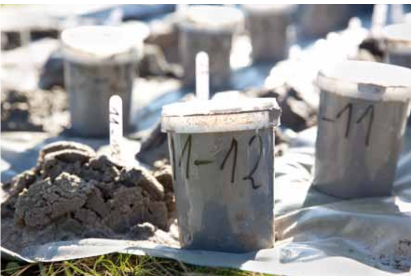
DIE BODENPROBEN GEBEN AUFSCHLUSS DARÜBER, OB UNTER DER ERDE WASSERFÜHRENDE SCHICHTEN VORHANDEN SIND.
